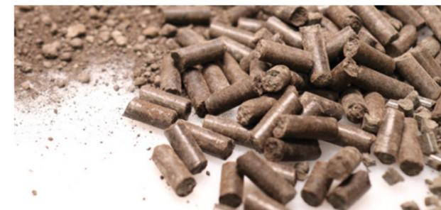
↑ Гранулированный шлам сточных вод
