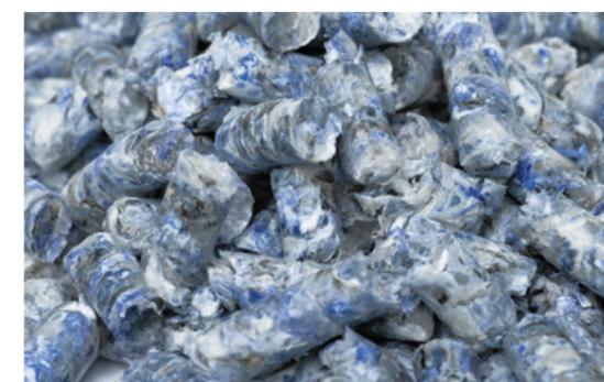
↑ Гранулы полиэтиленовых отходов
